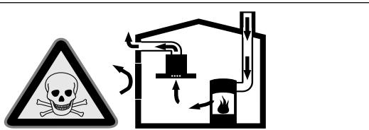
Les foyers à combustion alimentés en air ambiant (par exemple appareils de chauffage, au gaz, au bois, au fioul ou au charbon, les chauffe-eau, chauffe-eau accumulateurs) prélèvent l'air de combustion dans la pièce où ils sont installés et rejettent les gaz de fumée à l'extérieur par le biais d'un système spécifique (cheminée par exemple).
