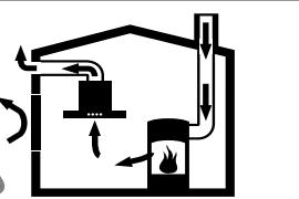
Vuurbronnen die de lucht in de ruimte verbruiken (bijv. apparaten die op gas, olie, hout of kolen worden gestookt, geisers, warmwaterketels) trekken de verbrandingslucht uit de opstellingsruimte en voeren de gassen via een afvoer (bijv. schoorsteen) af naar buiten.
