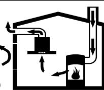
I focolari che dipendono dall'aria ambiente (peres. a gas, olio, legna o carbone, scaldabagno, caldaie elettriche) ricavano l'aria per la combustione dalla stanza ed eliminano i gas di scarico all'esterno attraverso un impianto (peres. camino).
