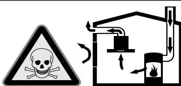
Os equipamentos de aquecimento que consomem o ar ambiente (p. ex. sistemas de aquecimento a gás, óleo, lenha ou carvão, esquentadores, cilindros) utilizam para a combustão o ar do local de montagem e transportam os gases de combustão para o exterior através de um sistema de exaustão (p. ex. uma chaminé).
