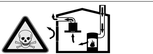
Los equipos calefactores que dependen del aire del recinto de instalación (p. ej., calefactores de gas, aceite, madera o carbón, calentadores de salida libre, calentadores de agua) adquieren aire de combustión del recinto de instalación y evacuan los gases de escape al exterior a través de un sistema extractor (p. ej., una chimenea).
